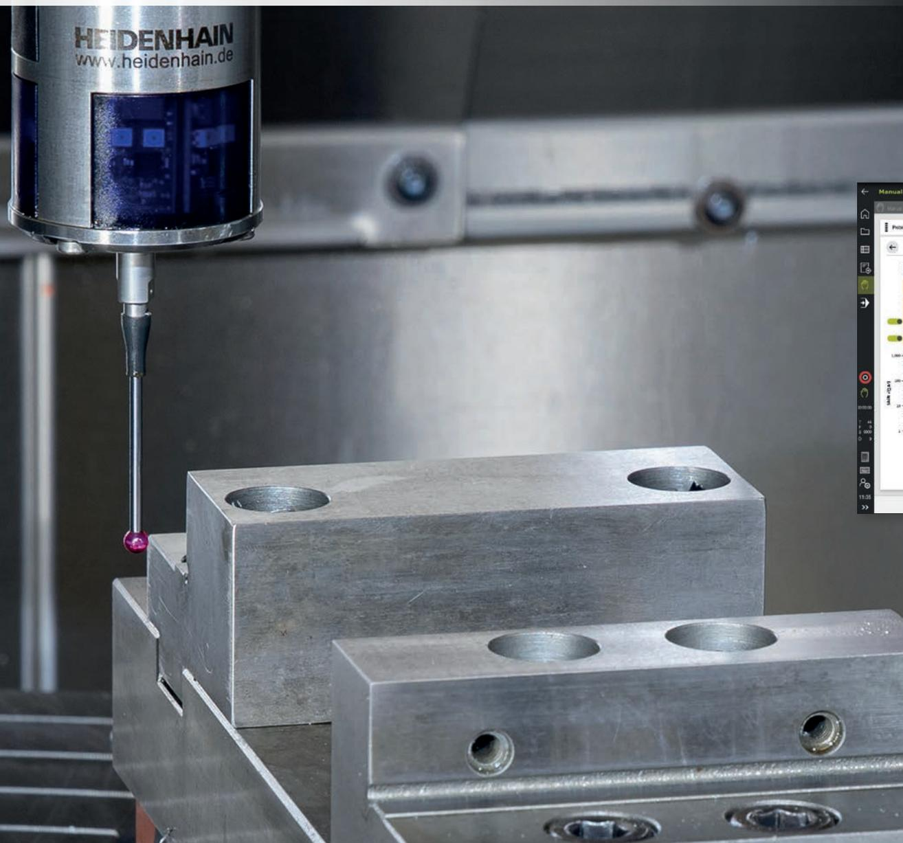
L'arrivée de la TNC7 marque aussi l'avènement du contrôle anticollision nouvelle génération. La fonction DCM, qui prévient le risque de collisions entre des composants de la machine et des outils, va encore plus loin, en permettant d'importer des moyens de serrage au format 3D, de les surveiller et de les mesurer facilement, avec assistance graphique, à l'aide d'un nouveau cycle.
