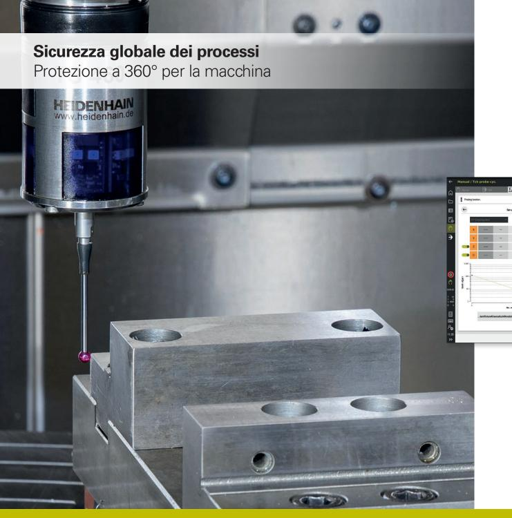
TNC7 porta l'opzione DCM (Dynamic Collision Monitoring) nella generazione successiva. DCM protegge non solo da collisioni tra componenti della macchina e utensili. Anche l'attrezzatura di serraggio può essere importata in formato 3D, monitorata e con un nuovo ciclo misurata in maniera semplice grazie al supporto grafico.
